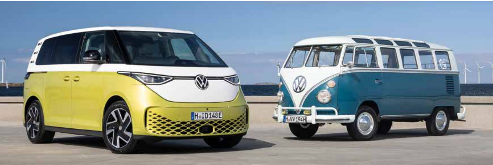
Der VW Bulli einst und heute: Der zwischen 1950 und 1967 gebaute T1 maß 4,280 m x 1,750 m x 1,940 m; sein 2022 eingeführter elektrischer Nachfolger ID. Buzz ist auf 4,712 m x 1,985 m (mit Außenspiegeln 2,212 m) x 1,951 m gewachsen, das Fahrzeugvolumen hat sich somit von 14,5 auf 18,25 m³ erhöht. Das Leergewicht (inkl. Fahrer) ist von (je nach Variante) 975 bis 1.150 auf 2.471 kg und die Leistung von 18 bis 32 auf 150 kW gestiegen.
